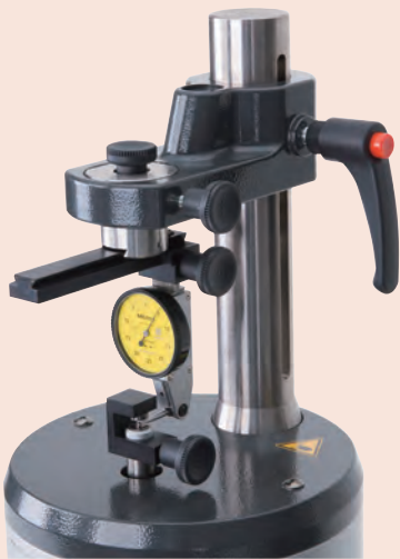
Калибровка рычажно-зубчатых индикаторов с дополнительными принадлежностями
