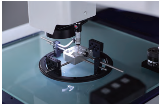
Quick Vision ACTIVE с контактным датчиком
