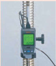
Цифровой индикатор Digimatic ID-H с кабелем 02AZD790D
