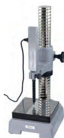
215-505-10 с датчиком линейных перемещений (опционально)
