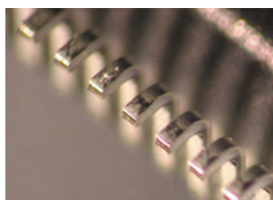
Пример измерения : высота пиков на QFP-корпусе
