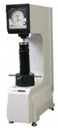
HR-210MR Твердомер по Роквеллу Ручное изменение веса (с выбором общей испытательной нагрузки) и управление предварительной нагрузкой. Моторизованный привод контролирует последовательность нагружения.
