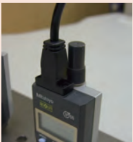
Индикатор ID-N ABS Digimatic с кабелем 02AZD790G
