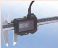
Штангенциркуль Super с кабелем 02AZD790A
