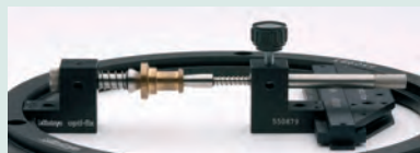
Удерживает цилиндрическую деталь между крепежными наконечниками.
