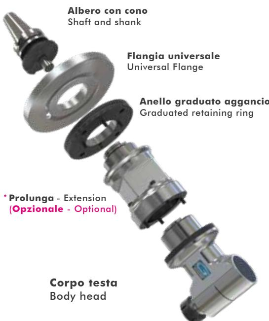
La cava a "T", ricavata sulla flangia universale, permette un facile posizionamento del corpo testa sui  $360^\circ$  intorno al suo asse verticale. Un sistema modulare componibile, rende possibile variare la lunghezza del corpo testa aggiungendo l'elemento di \*prolunga (Opzionale). Massimo 2 elementi di prolunga ammessi.
