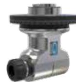
Linea di teste per le macchine non dotate di cambio utensili automatico. Le teste MTC (Manual Tool Change) vanno montate manualmente e fissate al mandrino tramite flangiatura. Sulle teste modello FMU, il supporto del mandrino portautensile ha la possibilità di inclinarsi e di posizionarsi di ±90°.
