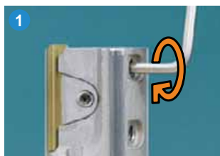
1. Плавно открутите регулировочные винты
