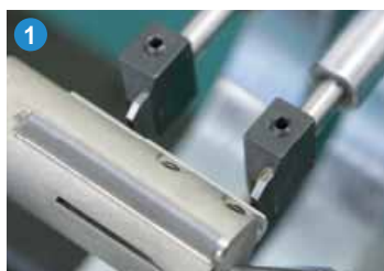
1. Установите индикаторы измерительных приборов на «0»
