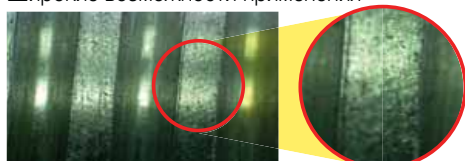
DST22 (vc = 100м/мин) Отличная обработанная поверхность
